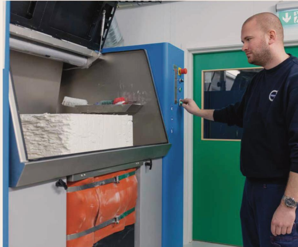
NY HÅRDVARA. Rickard Camp kontrollerar processen på Volvo Cars där hållare för skyddsvisir skrivs ut av en 3D-printer.
