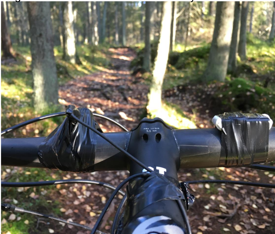
Figur 1. Två accelerometrar fästa till styret.
